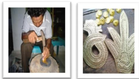
Gambar 8: Proses pengukiran motif pada logam (Foto: Peneliti 2023)
