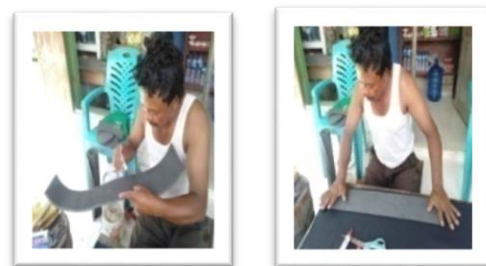
Gambar 12: Proses menggunting kain beludru bagian atas songkok Sumber: Peneliti (2023)
