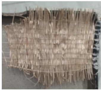
Gambar 2: hasil eksperimen penganyaman menggunakan benang serat pelepah pisang
