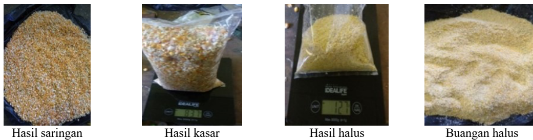
Gambar 6. Hasil Pengujian Biji jagung dengan Saringan Ø 6 mm
