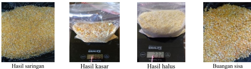
Gambar 5. Hasil Pengujian Biji jagung dengan Saringan Ø 3 mm
