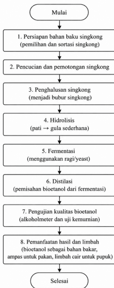
Gambar 4. Diagram Alir Proses Bioetanol Berbasisi Singkok
