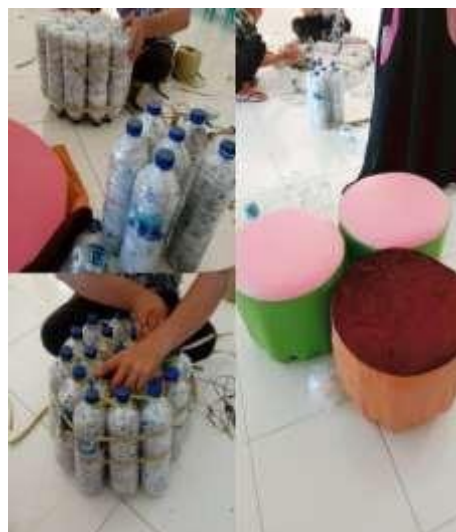
Gambar 2. Tahapan Pembuatan Sofa Rumah Tangga ( Ecobrick )
