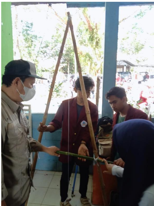
Gambar 3. Kegiatan Pembuatan Bandul Segitiga untuk Penetapan Garis Kontur
