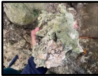
Gambar 4. Kenampakan Megaskopis Batugamping Packstone Pada Singkapan D2-FH18
