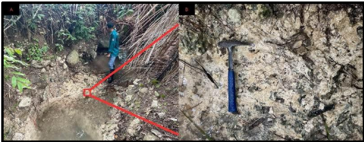
Gambar 3. Kenampakan Singkapan (A) dan Kenampakan Hand Specimen (B) Batugamping Packstone Pada Singkapan FH-18
