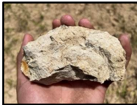
Gambar 10. Kenampakan Megaskopis Batugamping Mudstone Pada Singkapan FH-22
