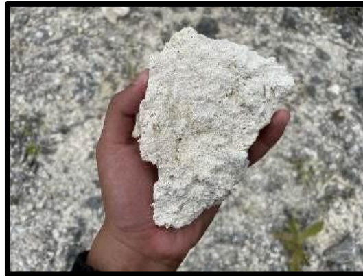
Gambar 7. Kenampakan Megaskopis Batugamping Wackstone Pada Singkapan FH-4
