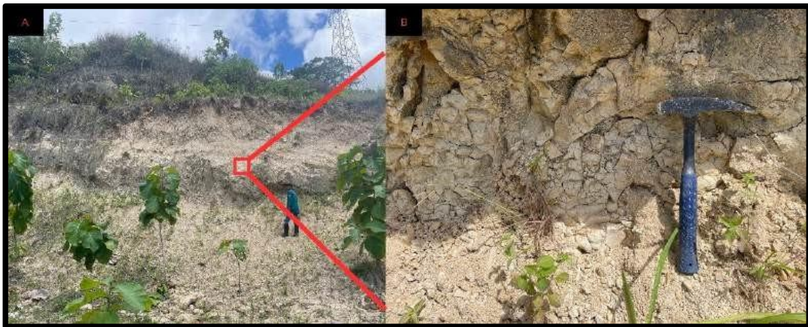
Gambar 9. Kenampakan Singkapan (A) dan Kenampakan Hand Specimen (B) Batugamping Mudstone Pada Singkapan FH-22
