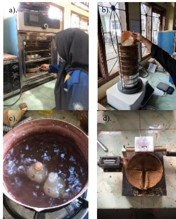
Gambar 3. a). Pengujian Kadar Air, b). Pengujian Analisis Saringan, c). Pengujian Berat Jenis, d). Pengujian Batas Atterberg
