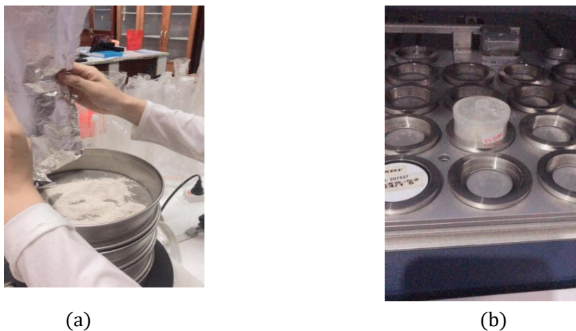
Gambar 2. Tahapan penyaringan sampel hasil milling (a) dan proses karakterisasi elemental sampel menggunakan X-Ray Fluorescence (XRF)
