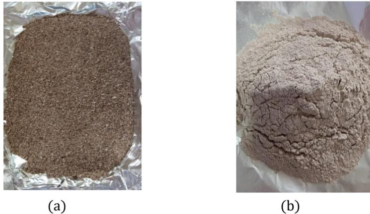
**Gambar 1.** Sampel Pasir Kurenai (a) sebelum dibersihkan dan (b) setelah dibersihkan dan milling selama 5 detik
