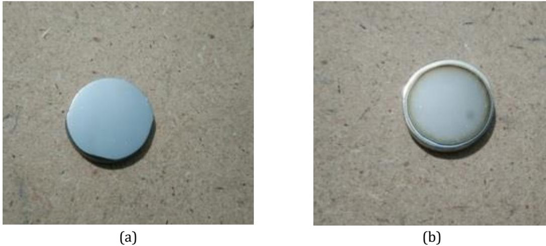
**Gambar 2.** (a) *Raw Material* sebelum *Sputtering* (b) Sampel pasca *Sputtering* 30 menit
