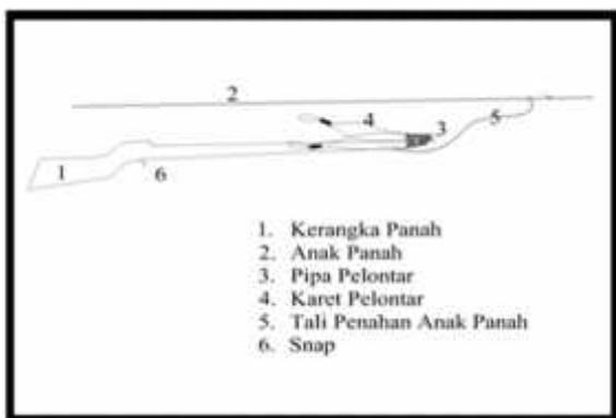
Gambar 1 Deskripsi Alat Tangkap Panah
