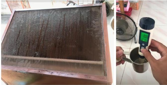
Gambar 7. Produk alat destilasi dan alat ukur TDS Meter
