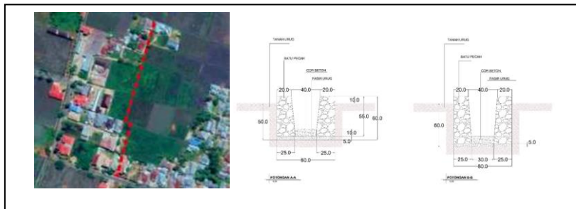
Gambar 1. Saluran drainase area persawahan di RT 003 / RW 001.
